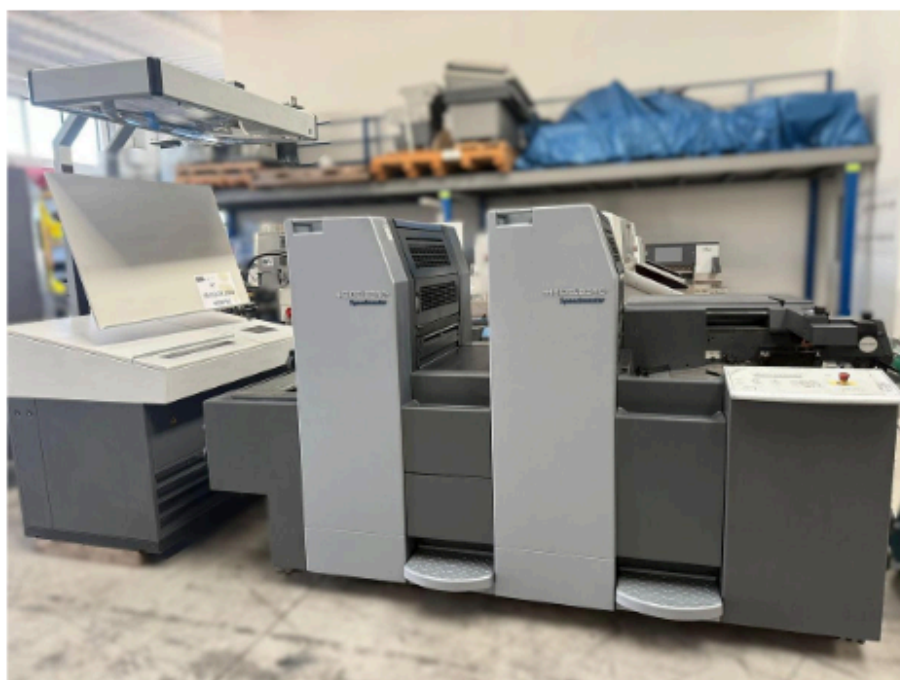
Figure 4: Unidade de perfeição da SM 52 - Impressão frente e verso
